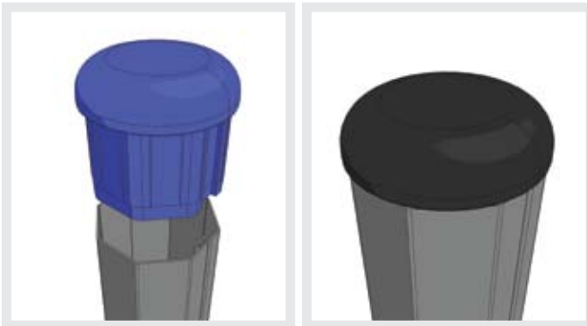
12. Поставить пластиковую заглушку на верхний торец несущего столба.
