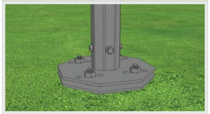
6. Закрепить несущие столбы ограждения на все опоры с помощью крепежа. Выровнять по уровню и высоте с помощью регулировочных винтов и отверстий на фланце несущего столба.
