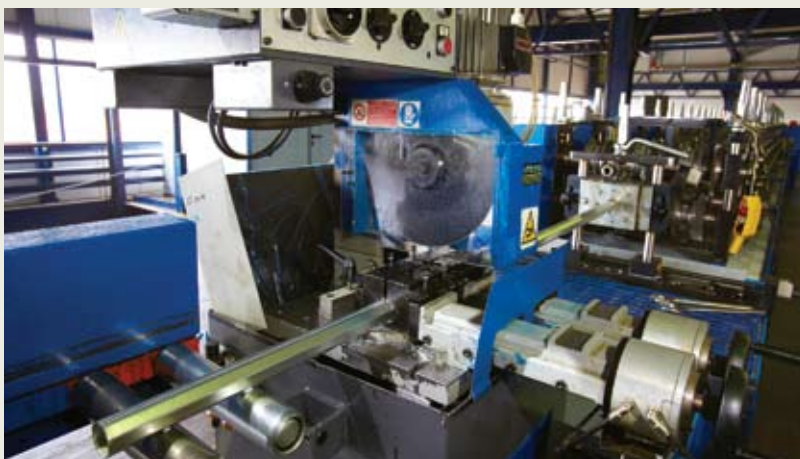
Производство несущих столбов на прокатной линии
