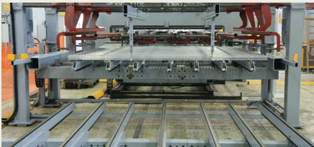
Производство панельных секций на автоматической линии
