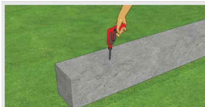
3. С помощью перфоратора сделать отверстия в бетонном основании под установку опорной пластины.
