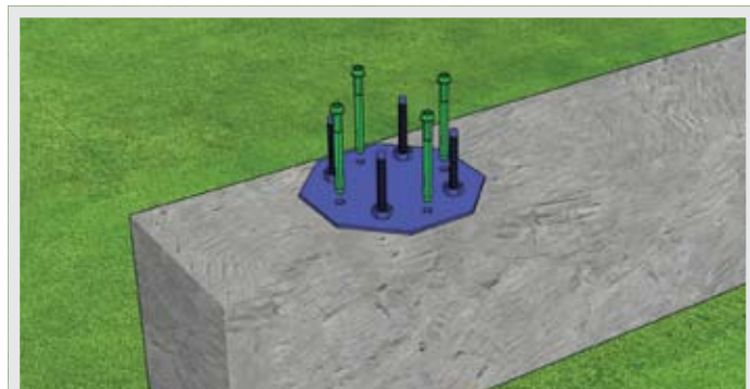
4. Установить опорную пластину на бетонное основание в местах установки несущих столбов. Закрепить на анкерные болты.
