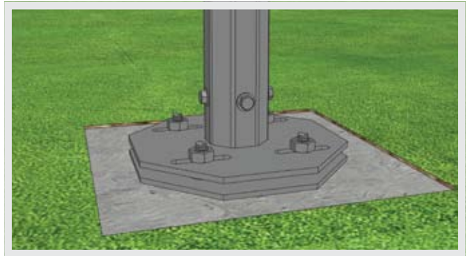
7. Закрепить несущие столбы ограждения на все опоры с помощью крепежа. Выровнять по уровню и высоте с помощью регулировочных винтов и отверстий на фланце несущего столба.
